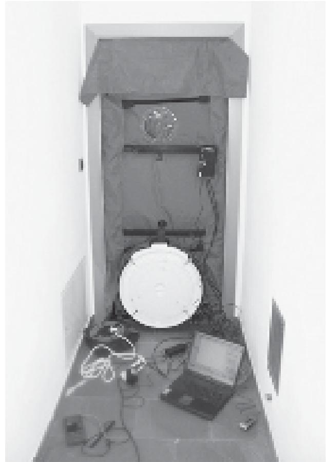
Empfehlenswert ist, die Luftdichtheitsmessung vor Bauende machen zu lassen, damit eventuelle Nachbesserungsarbeiten noch durchgeführt werden können. Die luftdichte Ebene (z.B. Putzarbeiten) muss allerdings abgeschlossen sein, außerdem müssen Fenster und Eingangstür bereits luftdicht eingebaut sein.
